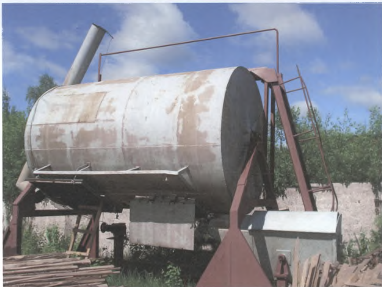
Рис. 2. Пиролизная установка с объемом рабочей камеры 12 куб. м.
